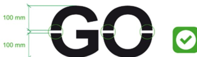
! se le lettere sono spezzate, l'altezza del singolo pezzo non dev'essere inferiore ai 100 mm
